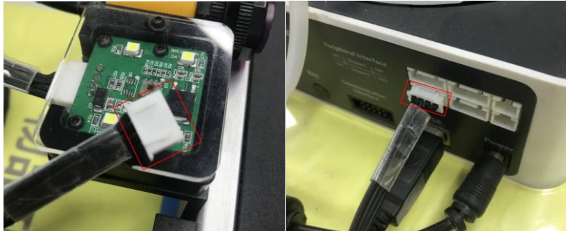
Zdjęcie 2.3. Podłączenie czujnika koloru.
